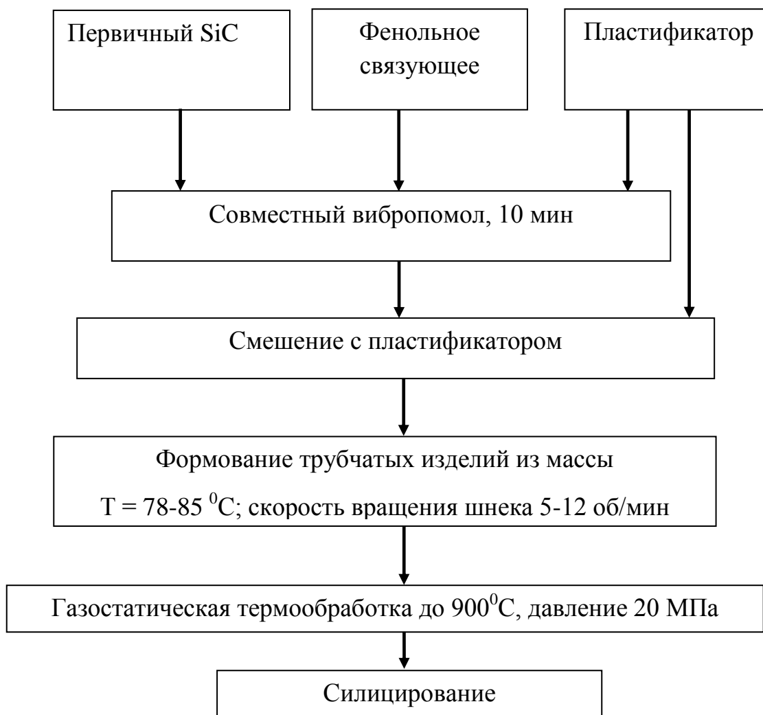
Рисунок 61 - Технологическая схема получения тонкостенных карбидкремниевых труб.
